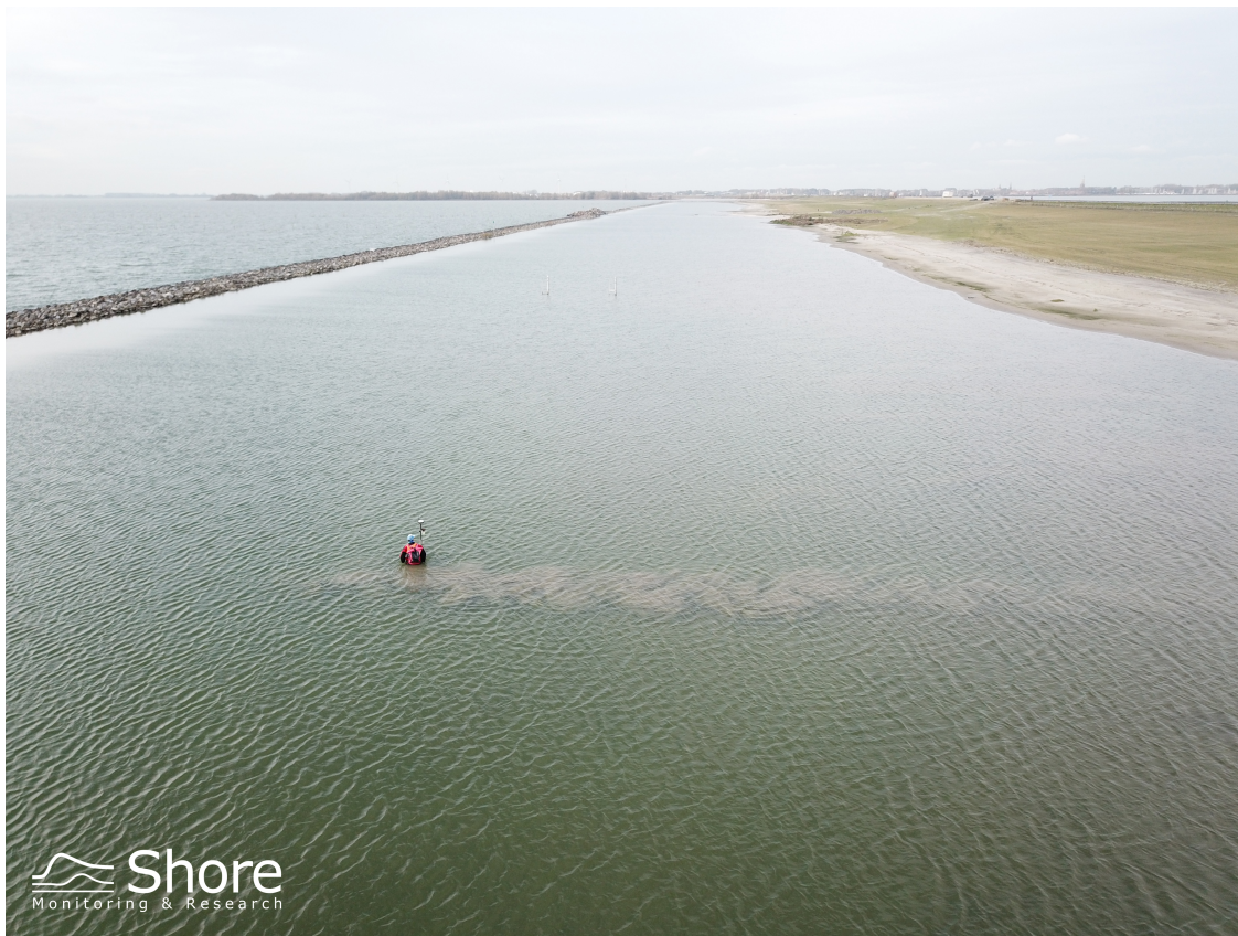
Figure 6.3: Hoogtemeting d.m.v. de GNSS kruiwagen tot borstdiep water bij D4.
