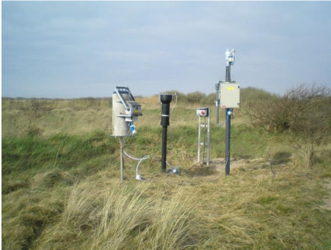
Figuur 2: Voorbeeld van een meetopstelling met van links naar rechts, een wet-only regenvanger, een bulk depositievanger, de 220V aansluiting, de paal met meteostation (bovenop) en deltadener (kast in het midden).
