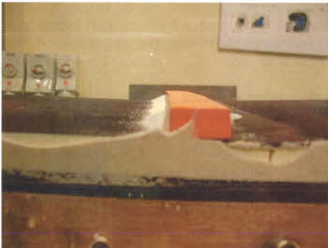
Figuur 22: Detailfoto met de duin gevormd tegen de huisjes na 20 seconden testtijd, 9 dagen in werkelijkheid.
