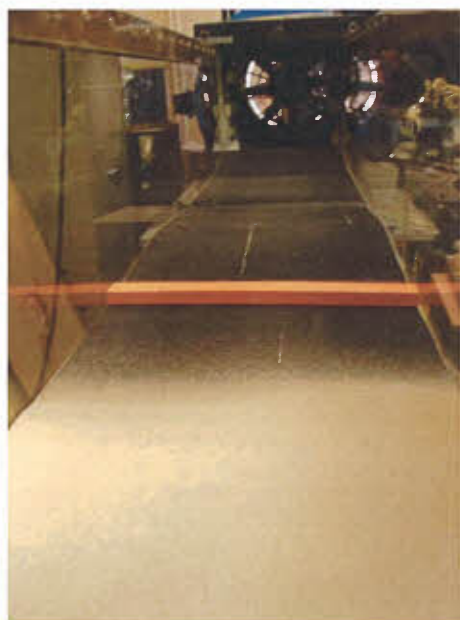
Figuur 20: 9m/s met huisjes bij aanvang der testen; 0.4l zand is initieel aangebracht en komt overeen met een zandlaagdikte van bijna 5mm, d.w.z. 1m in werkelijkheid.
