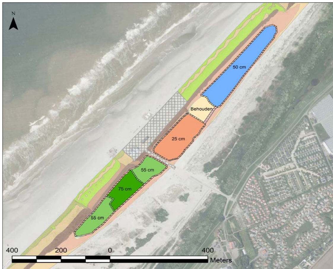
Figuur 3.1. Indicatie diepte van het af te graven deel (o.b.v. hoogtemetingen voorjaar 2017).
