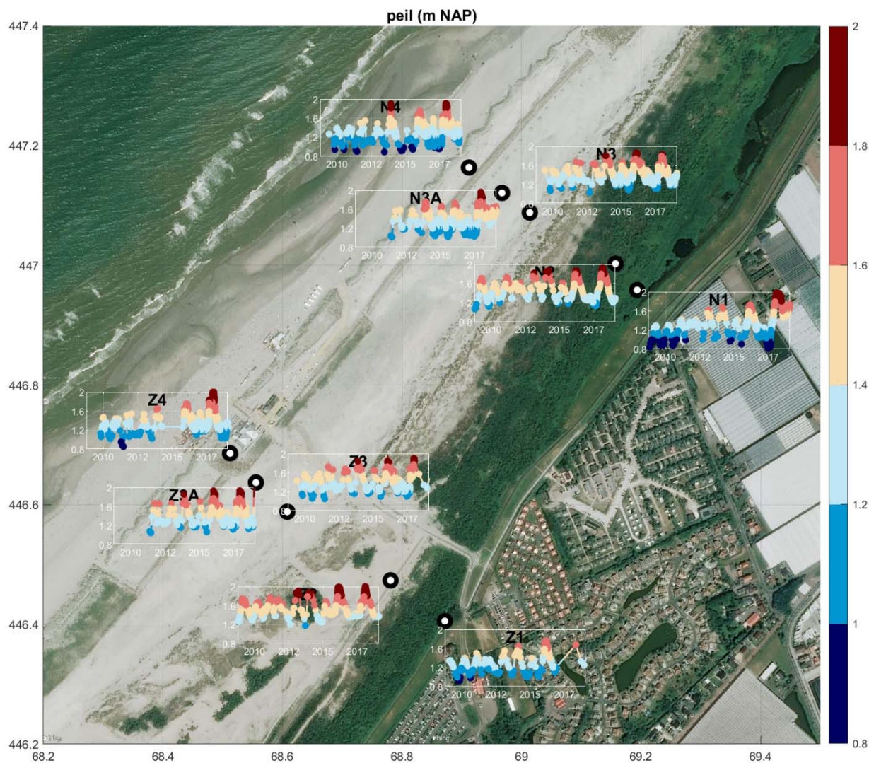
figuur 3: Stijghoogte-grafieken, in meter t.o.v. NAP, getekend bij de meetpunten. De kleur geeft als extra visuele hulp ook de stijghoogte aan.
