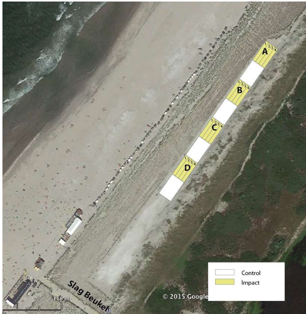
Figuur 1: Ligging proefvlakken (impact) en blanco's (control) met strokenverdeling (op tekening niet aangegeven, maar ook de 'control' vakken krijgen een gelijke virtuele strokenverdeling (Bron: Vertegaal et al., 2016).
