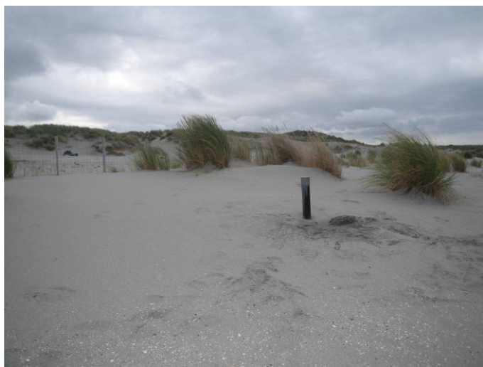
Foto 4 – Peilbuis Z3 afgewerkt met beschermkoker (oktober 2013)
