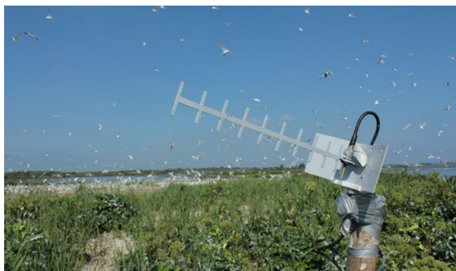
Figuur 2.2.4.3 Basisstation met antenne waarmee zenders automatisch worden uitgelezen en waarin een geheugenkaart zit waarop gegevens worden opgeslagen (Foto R. Fijn).
