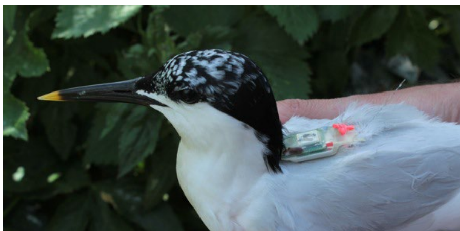
Figuur 2.2.4.2 GPS-logger bevestigd met harnas op de rug van een grote stern (Foto R. Fijn).
