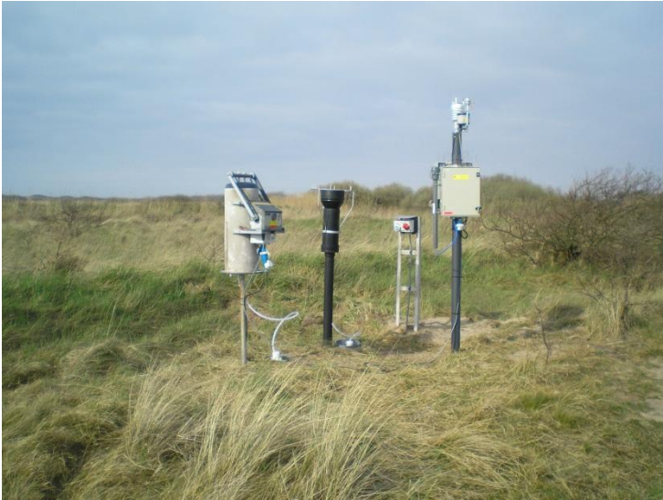
Figuur 2.1: Voorbeeld van een meetopstelling met van links naar rechts, een "wet-only" regen vanger, een bulk depositievanger, de 220 V aansluiting, de paal met meteostation (bovenop) en deltanuder (kast in het midden, zie hieronder)
