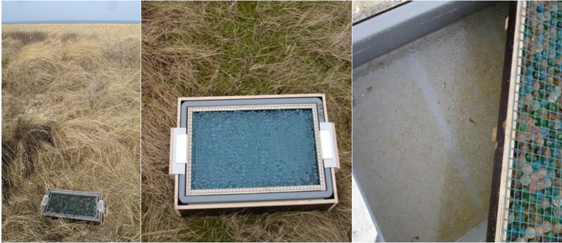
Figuur 4.2: MDOC sediment vallen voor het meten van de depositie.
