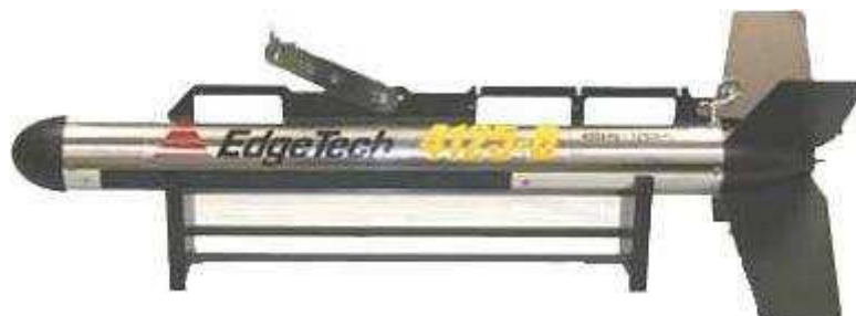
Afbeelding 6 – SideScanSonar vis zoals gebruikt voor het veldonderzoek.
