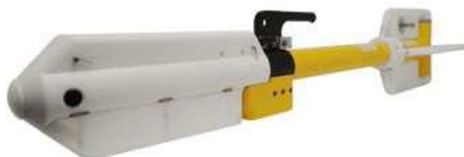
Afbeelding 7 – Geometrics G-880 magnetometer gebruikt voor het veldonderzoek
