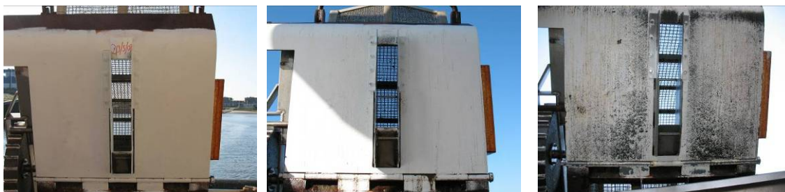
Figuur 10. Onderkant van voorste deel van bodemschaaf na aanbrengen van coating (links), na de eerste trek (midden) en na de laatste trek (rechts) op 20 mei 2008.
