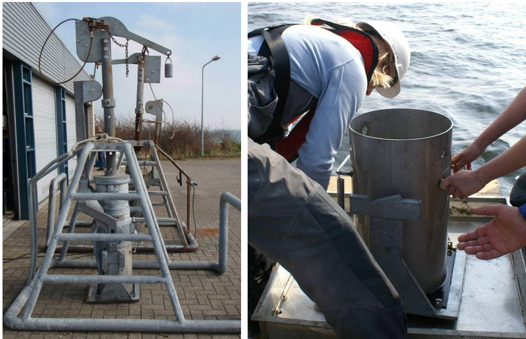
Figuur 2: Links: Gebruikte box-corers. Rechts: ketel met losgekoppelde schep op 1 mm zeef tijdens de bemonstering.
