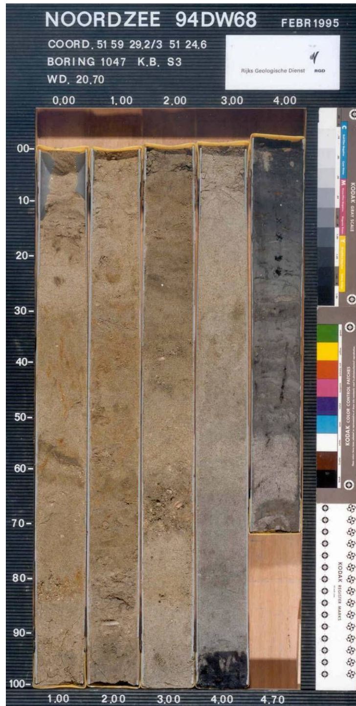
Figuur 6a: TNO-boring S3-1047. Een dunne veenlaag (zwart) bevindt zich op organische komklei.
