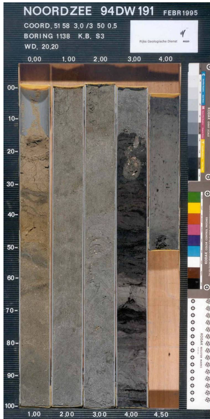
Figuur 6b: TNO-boring S3-1138. Een veenlaag (zwart) met later ingegraven boormosselen bevindt zich op organische komklei.
