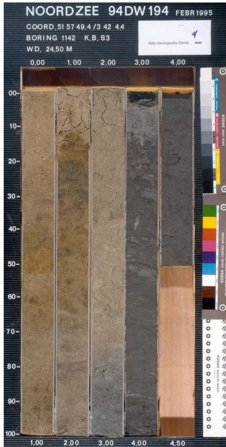
Figuur 7: TNO-boring S3-1142. Fijn zand met sliblaagjes is aanwezig vanaf een diepte van ongeveer 3 m. De donkere kleur wijst op de aanwezigheid van organisch materiaal, en contrasteert met die van de bovenliggende geelbruine zanden.
